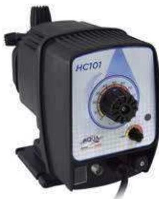
Bomba dosificadora de caudal constante con regulación manual de la carrera del pistón y la frecuencia de impulsos para una mayor precisión de dosificación.
