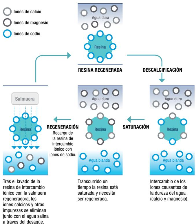
libera iones sodio. Cuando la resina ya ha intercambiado un gran número de iones de calcio y magnesio ya no se puede descalcificar más agua, y es necesario realizar una regeneración de la resina que permite recuperar su capacidad.
