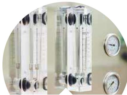
**A la salida de la membrana de ósmosis se obtienen dos flujos de agua: caudal de permeado y el de rechazo.**
