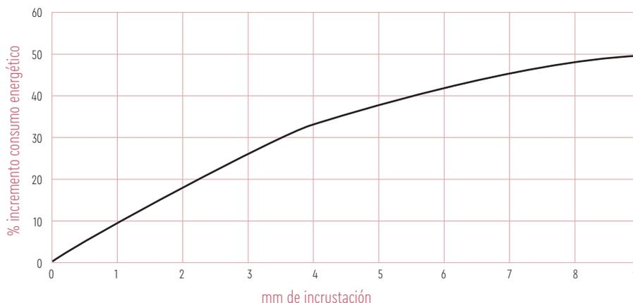
Una incrustación del grosor de la cáscara de un huevo incrementa el consumo energético en más de un 7%.
